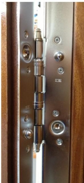
Conjunto de seguridad de 5 puntos de entrada. Cerradura central de 3 bulones planos de 20x14 mm en acero y 4 cajas auxiliares con 3 bulones en acero de 15 mm accionados desde cerradura central.
